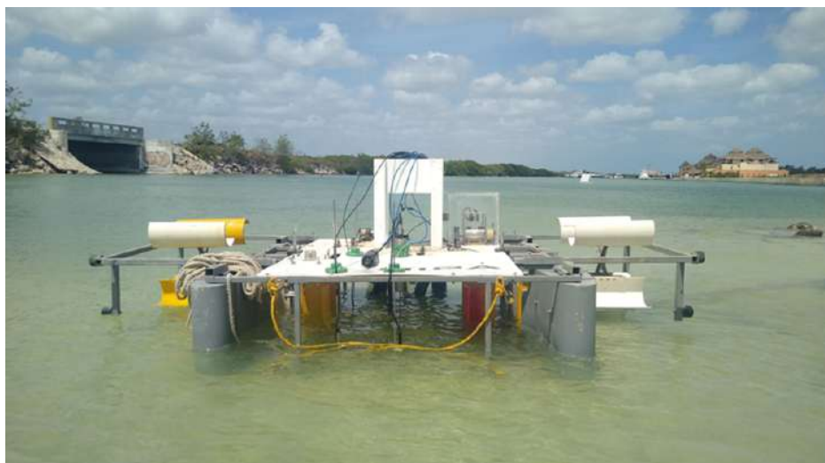
Figura 2 Hidrogenerador previo a una medición en estrechamiento de un puente vehicular en el puerto de Telchac
